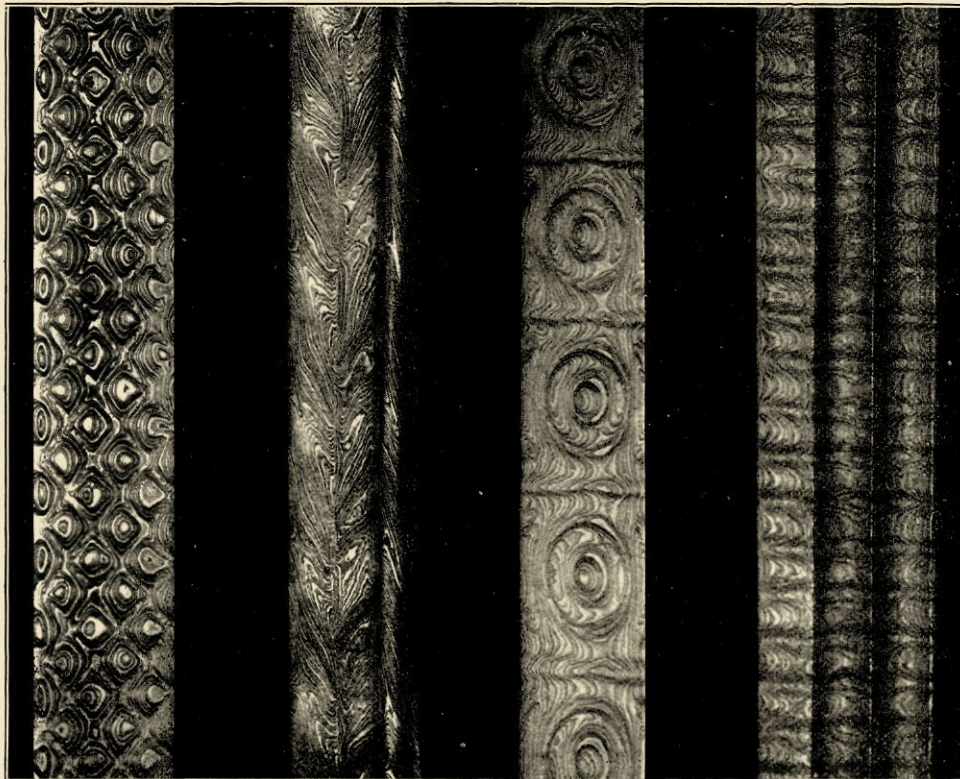
A B C D A. KLEIN ROZENDAMAST, B. TURKSCH DAMAST, C. GROOT ROZENORNAMENT, D. DAMASTPATROON. SMEEDWERK VAN PAUL DINGER TE SOLINGEN.
